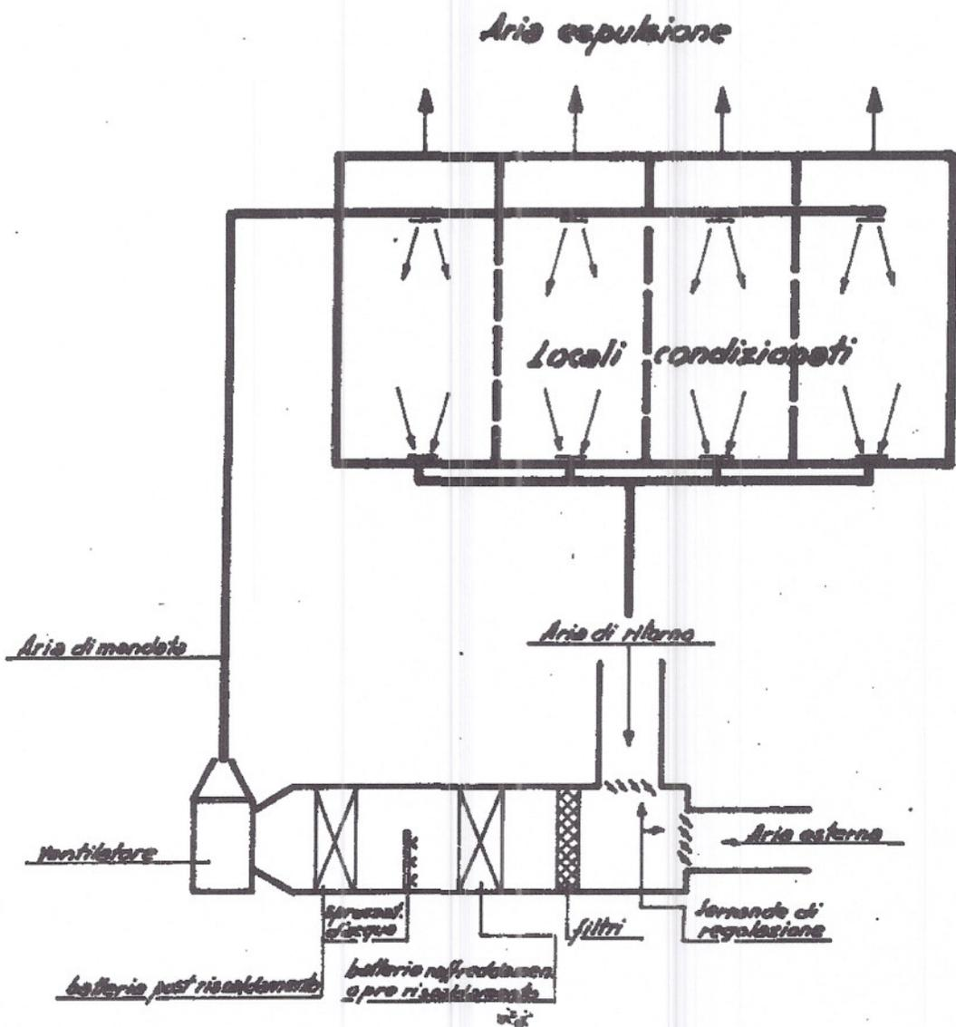
Schema d'impianto a tutta aria a bassa velocità
